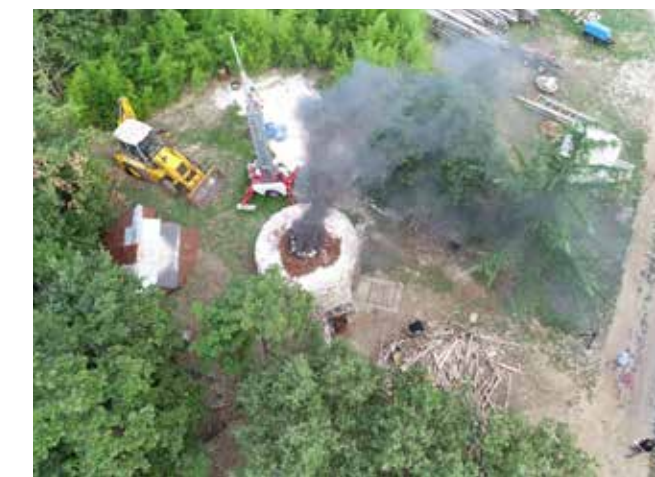
Traditioneller Kalkbrennofen in Istrien im Betrieb (Foto: ÖÖ. Landesmuseum)
