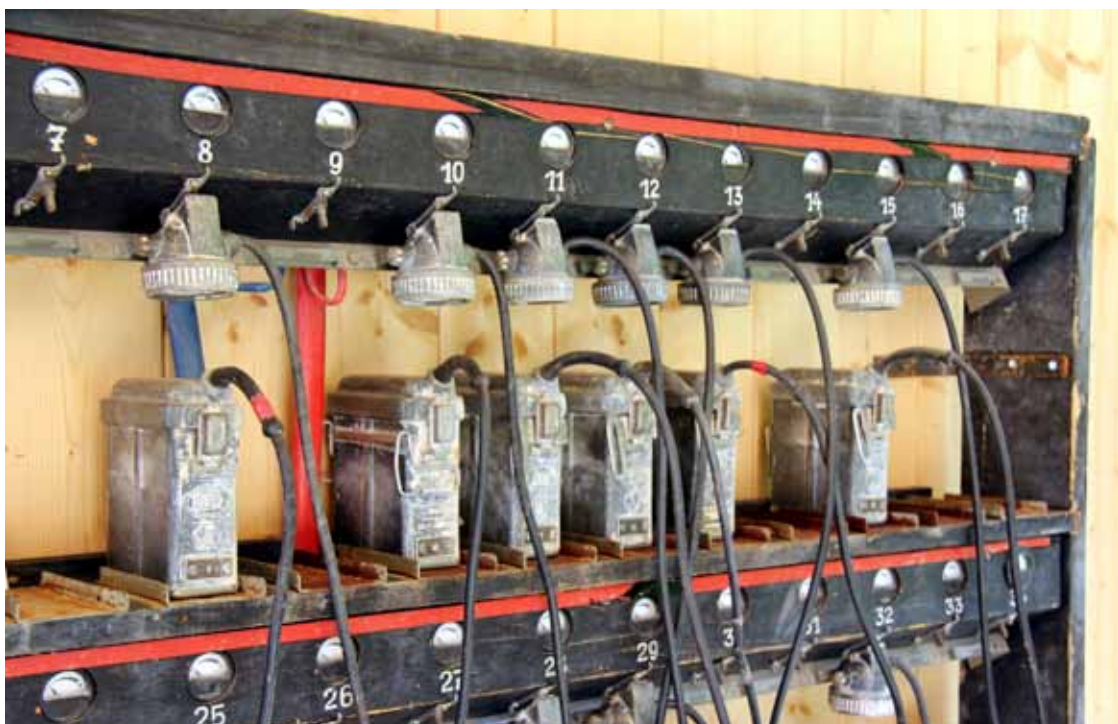
Akkulampen in der so genannten Lampentube, aus der letzten Betriebszeit des Untertage-Abbaues
