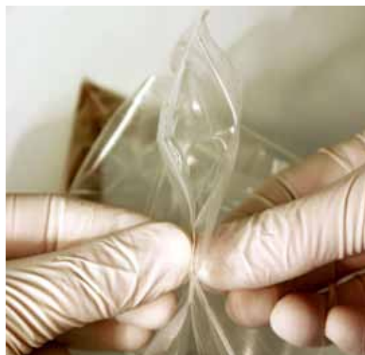
Einschweissen von archäologischem Eisen mit Trockenmittel zur Korrosionsprävention (Foto: Susanne Heimel)
